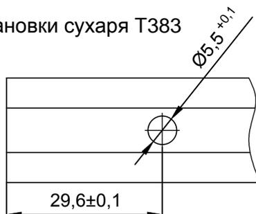
Отверстие  $\varnothing 5,5$  мм целесообразно выполнять на пробойнике ПК148 с комплектом инструмента ПК344 или с помощью кондуктора ПК367.
