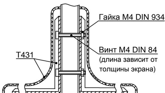
Рис.7.10 Пример установки экрана с помощью кронштейнов Т431
