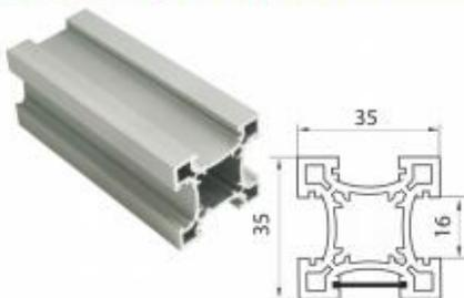
Несущий профиль - основа системы. Симметричное квадратное сечение 35\*35 мм с вогнутыми полками со всех 4х сторон. Монтажные пазы ( на каждой из сторон) предусматривают, помимо крепления элементов, установку в профиль плит толщиной 16 мм. В соответствующие пазы возможна установка светодиодной подсветки, а также стандартной кромочной ленты 2\*19 мм для придания профилю любого необходимого декора.
